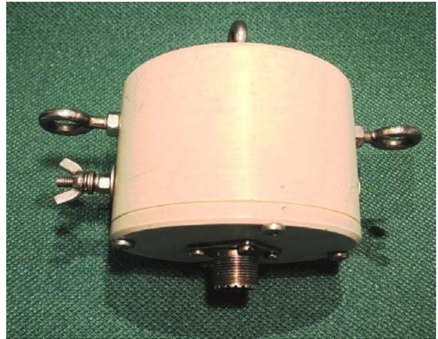
Il balun così come descritto può essere impiegato agevolmente con potenze sull'ordine di 600/700 Watt, per potenze superiori sostituire il toroide, utilizzare il modello FT240-43 o ancora meglio FT290-43, aumentare inoltre di qualche decimo (1.8-2mmq) la sezione dei cavi per gli avvolgimenti.
