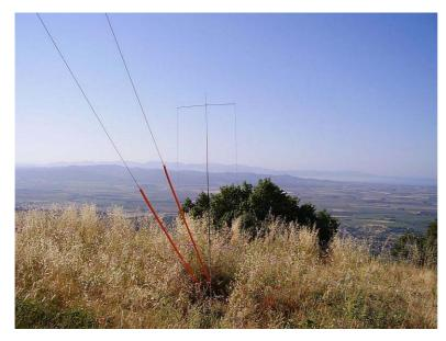
Prove sul campo effettuate sulle alture livornesi, in JN53HC, hanno permesso, in fase di paragone con una tre elementi a boom corto, del guadagno di 5,5 dBd, un immediato collegamento in SSB con la stazione inglese M0AEP, situata nel locatore IO93SO, con la potenza di uscita del mio FT817 regolata a 500 milliwatt.
