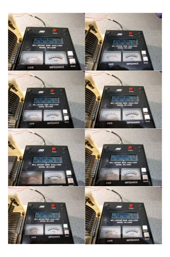
Die obere und untere maximale abstimmbare Frequenz liegt bei ca. 3 und 40 MHz.
