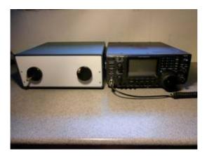
Der Z-Match-Koppler hat einen sehr hohen Wirkungsgrad an niederohmigen Antennen wie z.B.:
