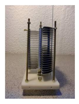
Die Statorplatten werden einfach mit den Muttern in die richtige Position gebracht. Der erste Drehkondensator ist nun fertig.
