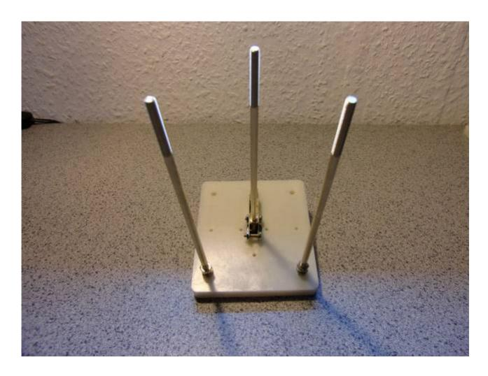
Nun werden die Rotor- und Statorplatten mit den Abstandhaltern auf die Stäbe geschoben.
