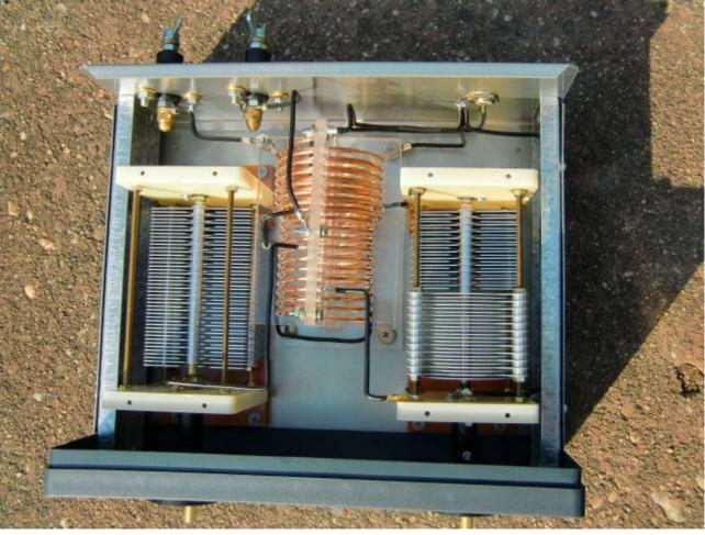
Ein paar Stunden Arbeit sollte man hierfür einplanen. Dazu kommt, dass sich die Werte durch den Einbau der Bauteile in das Gehäuse leicht verändern - und somit auch die Abgriffspunkte der Spule. Daher kann man nach dem Einbau der Bauteile diese provisorisch mit Krokokabeln (gleiche Länge wie die, die nachher verbaut werden) verdrahten, und noch einmal die richtigen Abgriffpunkte mit dem Analyzer suchen.
