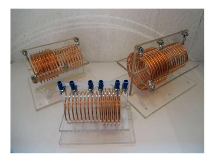
Die Spule in der Mitte ist das Original mit 2mm Kupferdraht. Die linke Spule ist mit 4mm Kupferdraht und dem Wickelverhältnis 17 zu 7 Windungen gebaut (diese kam letztendlich zum Einsatz in meinem Koppler). Die rechte Spule ist mit 6mm Kupferdraht und dem Wickelverhältnis 17 zu 7 Windungen gebaut. Diese wird dann in meinem nächsten QRO-Koppler verbaut werden.
