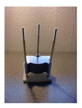
Mit der Stange zwischen den Rotorplatten werden diese ausgerichtet und danach befestigt.
