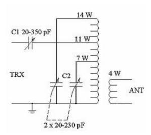
Das Herzstück ist die Luftspule, die nach Anleitung von DL3BCU selbst nachgebaut werden kann. Benötigt wird eine Plexiglasscheibe, aus der man zwei Platten mit 120 mm x 90 mm schneidet. In der Mitte wird ein Schlitz gesägt, um nachher die Platten rechtwinklig zusammenstecken zu können.
