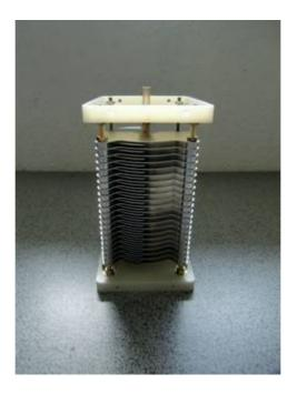
Der Splittdrehkondensator wird danach mit derselben Prozedur fertig gestellt. Nur das Justieren der Rotorplatten ist etwas anders und wird mit zwei zusätzlichen flachen Blechen bewerkstelligt.
