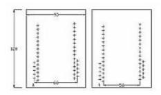
Danach druckt man die Bohrvorlage aus, legt diese unter die Plexiglasscheibe und bohrt die Löcher mit der Bohrmaschine.
