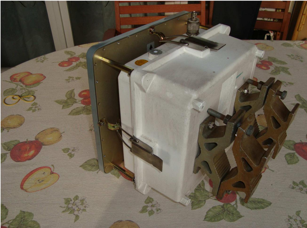
In particolare se utilizzato per i 24 Ghz , dispone già' al suo interno della transizione in guida d'onda adatta, al collegamento immediato ad una antenna parabolica, altrimenti ad una guida flessibile verso l'illuminatore o tromba dedicata.
