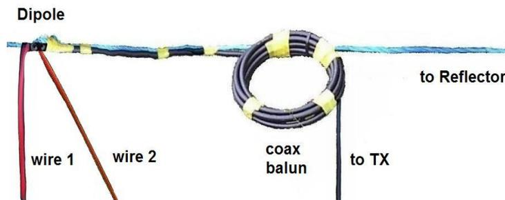
Les fils du dipôle sont connectés au câble coaxial via un double sucre électrique. Celui-ci étant également fixé à la corde de support principale via un simple nœud. Ensuite un balun coaxial aussi attaché à la corde amène le signal vers le TX. Dans une prochaine version de l'antenne, j'utiliserai un balun léger 1:1 pour réduire le poids sur le support principal.
