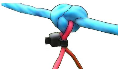
**Remarque :** Un nœud dans la corde de support n'est pas recommandé mécaniquement et n'est pas une solution long terme car les tensions pourraient endommager la corde. Je pense dans une deuxième version d'antenne à une solution sans nœud.
