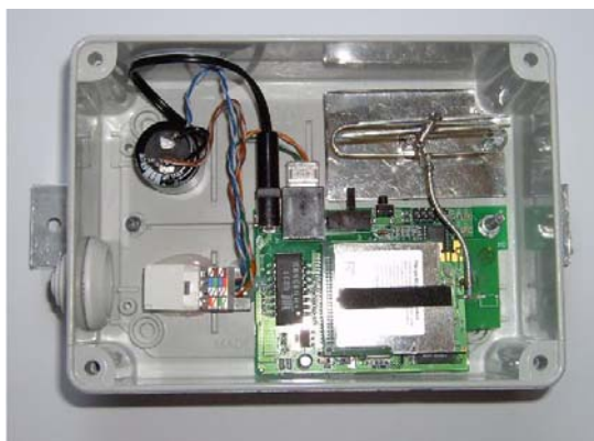
foto del prototipo dell'antenna montata all'interno di una scatola da esterno con scheda wifi e POE
